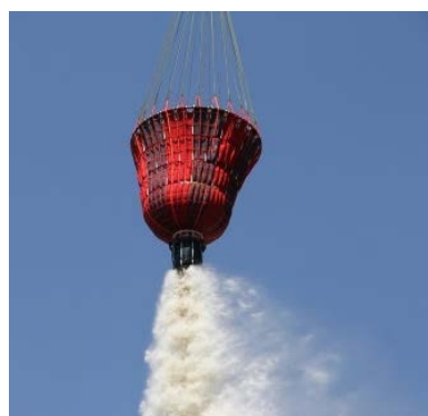
Водосливное устройство ВСУ-5А
